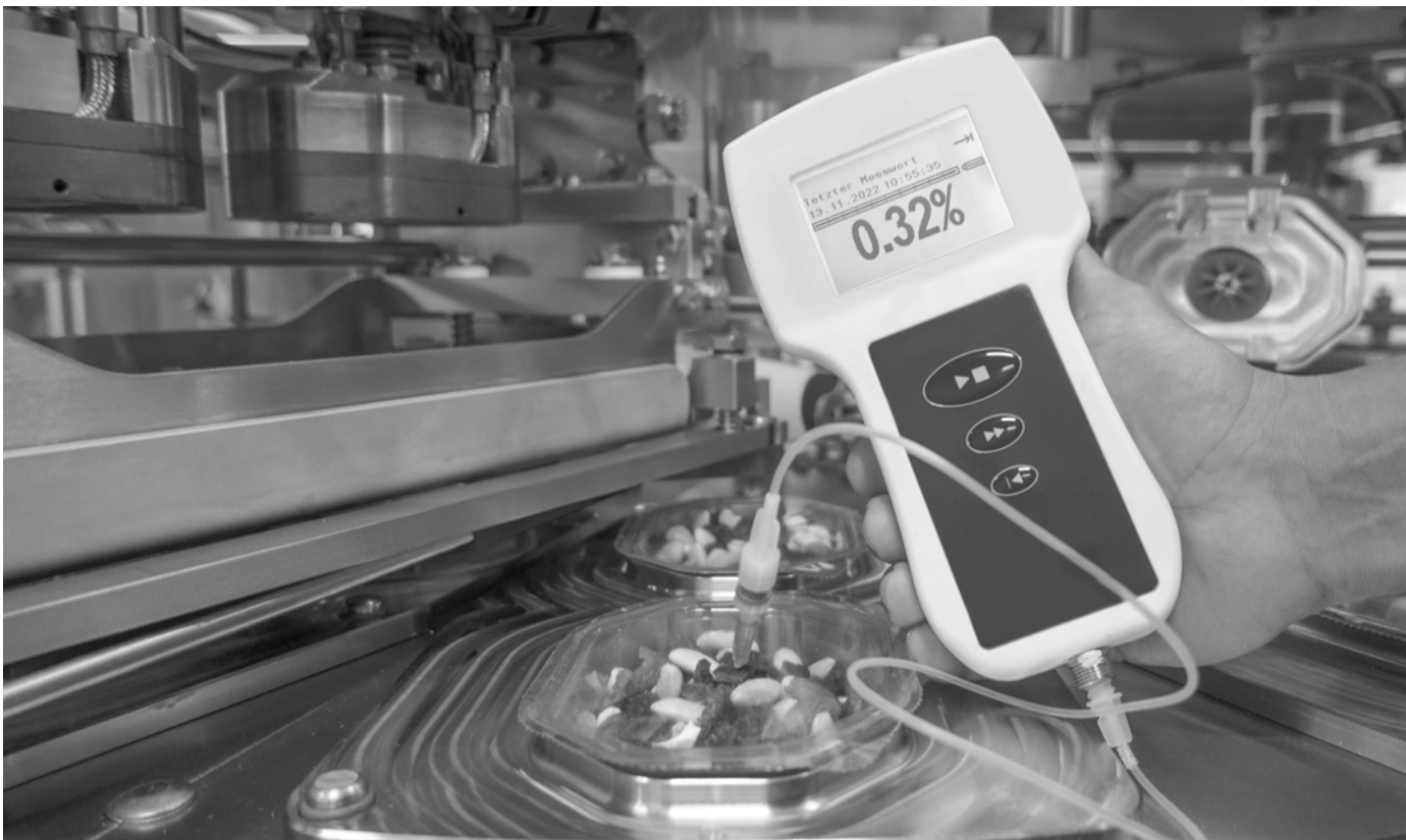
Das neue Grunwald-Begasungssystem ermöglicht < 0,5 % Restsauerstoffgehalt bei 40 Takten/Min.
