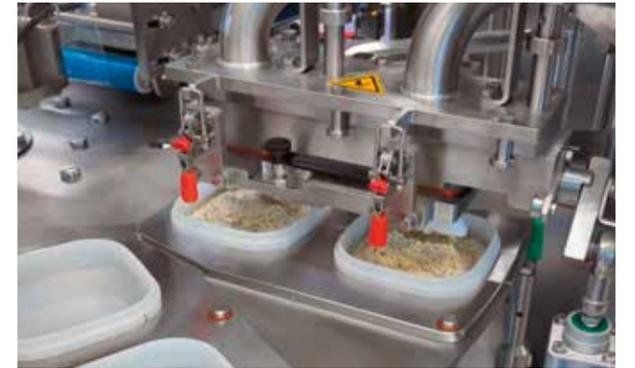
Dosierstation mit integrierter Waage mit
