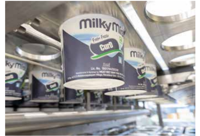
Blick in den 8-bahnigen Längsläufer GRUNWALD-FOODLINER 20.000 während der Becherabfüllung
