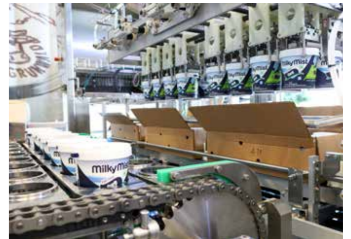
Blick in den 8-bahnigen Längsläufer GRUNWALD-FOODLINER 20.000 während der Becherabfüllung
