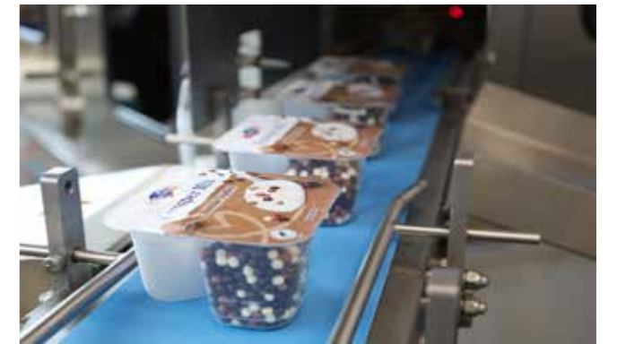
Einblick in den 4-bahnigen Ultra-Clean-Rundläufer GRUNWALD-ROTARY 20.000E-UC
